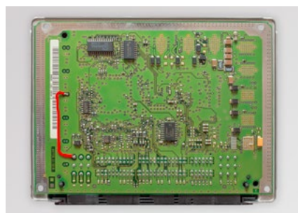
Abb. 2: Fehlen der Zündansteuerung, z. B. Stecker 5, Pin 9
