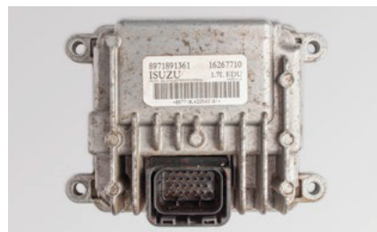
Nicht zu verwechseln mit dem Motorsteuergerät, so sieht das Pumpensteuergerät aus.
