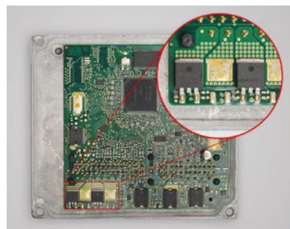
Kleines Bauteil, große Wirkung. Über den Lupenausschnitt erkennen Sie die gekennzeichneten Zündtransistoren im Motorsteuergerät.
